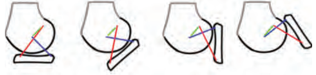
Resim 2. Dizde mekanik olarak 4'lü bar. Soldan sağa doğru diz fleksiyonu sırasında 4'lü barın ilişkisi ve femoral yuvarlanma.
