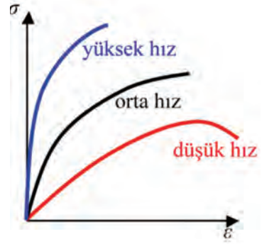
Şekil 19. Farklı hızlarda uygulanan kuvvetler sonucunda viskoelastik bir malzemenin göstereceği gerilme-gerilme davranışı.
