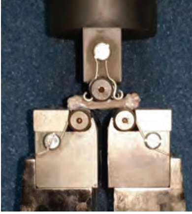
Şekil 28. a) Sığıçanlara ait femur kemiklerine uygulana üç noktadan eğme testi. b) Test sonucunda elde edilen kuvvet-şekil değişimi grafiği.
